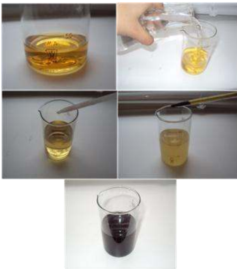
Рисунок 4 – Последовательность операций при определении аскорбиновой кислоты
