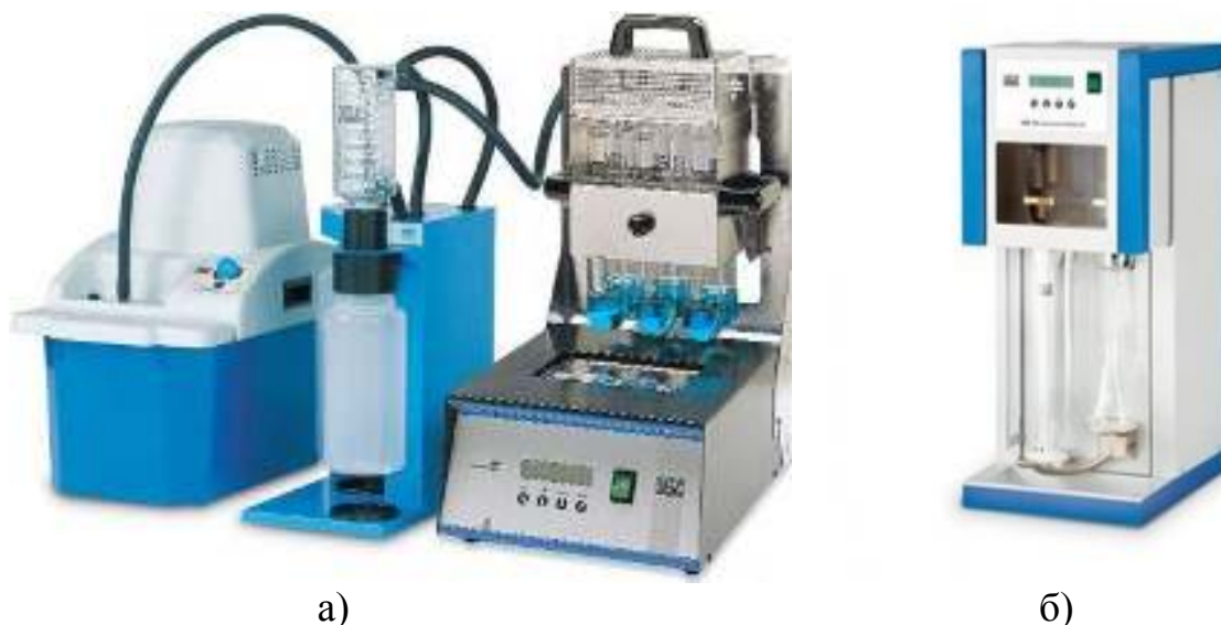
Рисунок 1 - Полуавтоматическая установка Кьельдаля UDK-132: а) печь для разложения проб в сборе со скруббером; б) установка для перегонки проб с паром
